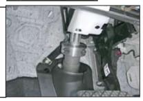
10. Сорвать головки болтов и гаек крепления замка (1).
