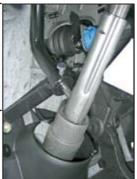
9. Заблокировать рулевой вал штатным замком. Установить на вал муфту (3) и закрепить ее болтами (4). Отрегулировать положение муфты так, чтобы блокирующий ригель свободно входил и выходил из паза муфты в верхнем и нижнем положениях регулируемой рулевой колонки. Внимание! При проверке регулировки муфты нельзя поворачивать рулевой вал более, чем на 90° от точки блокировки, потому что срывные головки болтов муфты могут ударить по носику замка (1) и заклинить блокирующий ригель.
