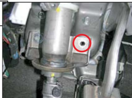
5. Установить замок (1) и закрепить его гайками (5) и болтом (6), крепеж затянуть с предварительным усилием 15 н.м.
