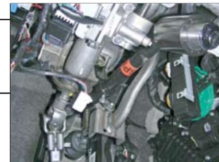
6. Заблокировать рулевой вал штатным замком. Установить на вал муфту (2) и закрепить ее болтами (3). Отрегулировать положение муфты так, чтобы блокирующий ригель свободно входил и выходил из паза муфты. Внимание! При проверке регулировки муфты нельзя поворачивать рулевой вал более, чем на 90° от точки блокировки, потому что срывные головки болтов муфты могут ударить по носику замка (1) и заклинить блокирующий ригель.
