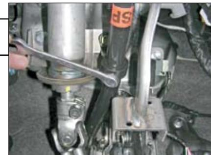
8. Еще раз проверить регулировку муфты. Сорвать головки болтов муфты так, чтобы зазор между половинами был равномерным.
