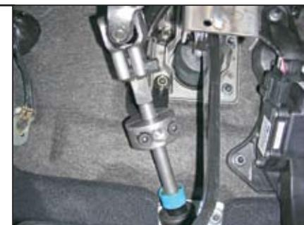
7. Сорвать головки болтов и гаек крепления замка (1).
