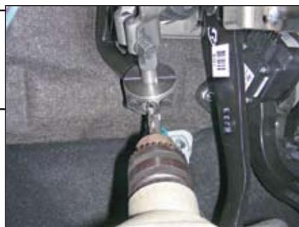
10. Разметить и отфрезеровать отверстие D=38 мм в пластиковой панели для личины замка. Установить декоративное кольцо (8). Установить панель на место.
