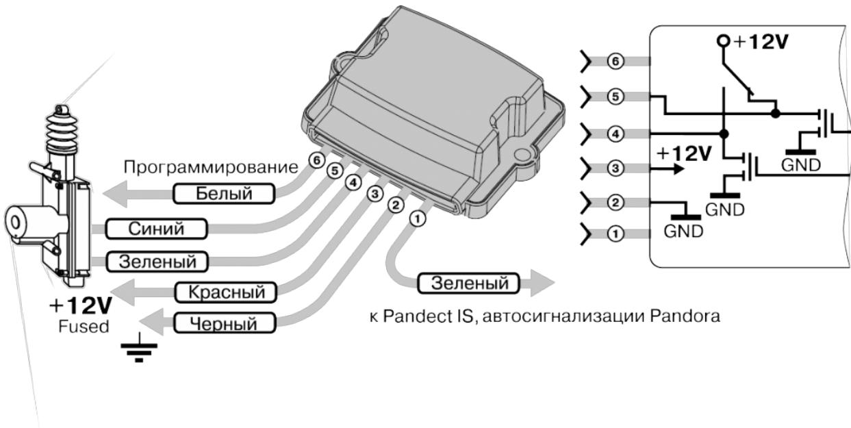
**Провод «1» (зеленый)** модуля управления должен быть присоединен к управляемому проводу 7 разъема X7 (зеленый) (CH4) базового блока автосигнализации **Pandora DXL**.
