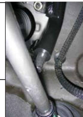
8. Заблокировать рулевой вал штатным замком. Установить на вал муфту (2) и закрепить ее болтами (3). Отрегулировать положение муфты так, чтобы блокирующий ригель свободно входил и выходил из паза муфты в верхнем и нижнем положениях регулируемой рулевой колонки. **Внимание!** При проверке регулировки муфты нельзя поворачивать рулевой вал более, чем на 90° от точки блокировки, потому что срывные головки болтов муфты могут ударить по носику замка (1) и заклинить блокирующий ригель.
