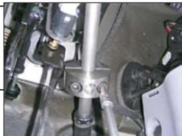
11. Завинтить стопорный болт (4) до срыва головки.
