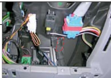
6. Установить замок (1) и закрепить его гайками (5) и болтом (6). Крепеж не затягивать.
