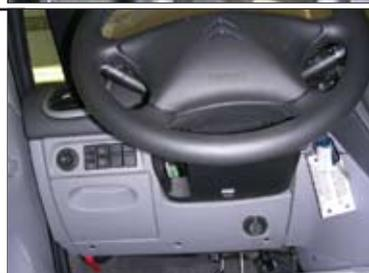
13. При установке кожуха в области педалей вырезать его часть так, чтобы муфта замка не цепляла за кожух в верхнем и нижнем положении регулируемой рулевой колонки.
