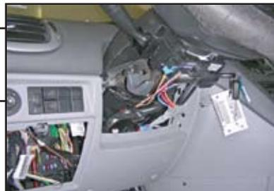
2. Демонтировать пластиковую панель под рулевой колонкой.
