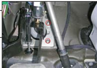
4. Отвинтить нижний правый болт крепления рулевой колонки.
