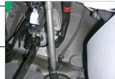
7. Выдвинуть блокирующий ригель замка (1), отрегулировать положение замка так, чтобы ригель попадал в центр рулевого вала. Затянуть крепеж замка с предварительным усилием 15 н.м.
