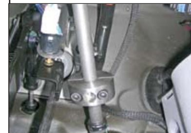
9. Сорвать головки болтов и гаек крепления замка (1).
