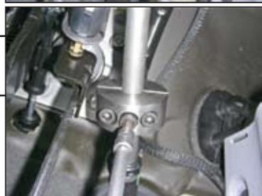
12. Разметить и отфрезеровать отверстие D=38 мм в пластиковой панели для личины замка. С внутренней стороны панели удалить ребра жесткости на 10 мм от края отверстия. Установить кольцо (8). Установить все пластиковые панели на место.
