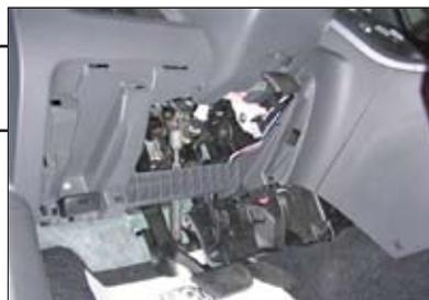
2. Отвинтить левую нижнюю гайку крепления тормозного цилиндра.
