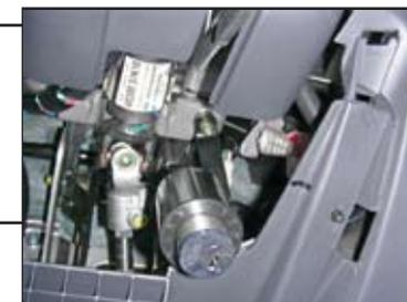
7. Опустить регулирующую рулевую колонку в нижнее положение. Затянуть гайки крепления кронштейна (2) с предварительным усилием 15 н.м. Отрегулировать расстояние от рулевого вала до носика замка, оно должно составлять 23 мм. Затянуть стопорный болт (7) кронштейна (2) с предварительным усилием 5 н.м.
