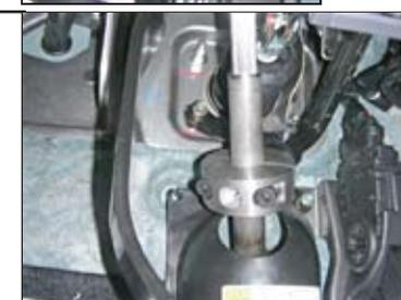
10. Сорвать головки болтов и гаек крепления замка (1).
