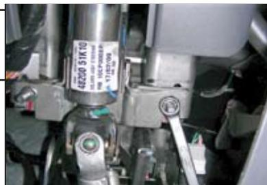
5. Установить кронштейн (2) на шпильки и закрепить гайками (6), крепеж не затягивать.
