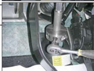
13. Разметить и отфрезеровать отверстие D=38 мм в пластиковой панели для личины замка. Установить кольцо (8). Установить панель на место.
