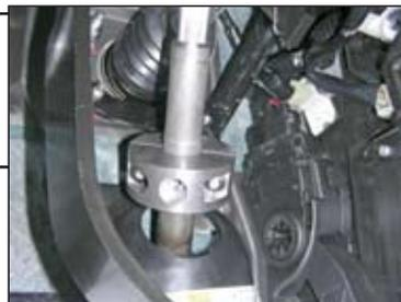
12. Завинтить стопорный болт (5) до срыва головки.
