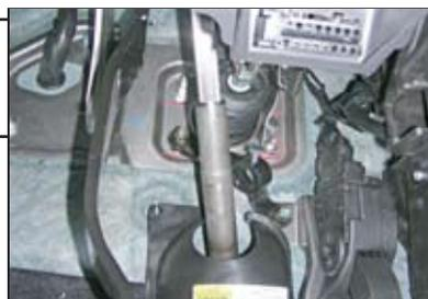
6. Установить замок (1). Для этого вставить носик замка в кронштейн (2) и закрепить его гайкой (6). Крепеж не затягивать.
