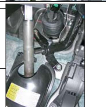
9. Заблокировать рулевой вал штатным замком. Установить на вал муфту (3) и закрепить ее болтами (4). Отрегулировать положение муфты так, чтобы блокирующий ригель свободно входил и выходил из паза муфты в верхнем и нижнем положениях регулируемой рулевой колонки. **Внимание!** При проверке регулировки муфты нельзя поворачивать рулевой вал более, чем на 90° от точки блокировки, потому что срывные головки болтов муфты могут ударить по носу замка (1) и заклинить блокирующий ригель.
