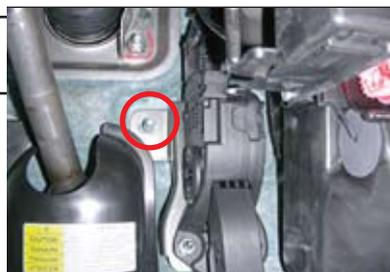
4. Проверить затяжку нижней правой гайки крепления рулевой колонки.
