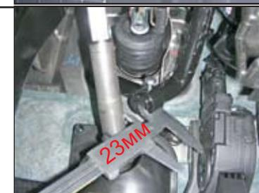
8. Выдвинуть блокирующий ригель замка. Отрегулировать положение замка так, чтобы блокирующий ригель попадал в центр рулевого вала. После этого затянуть крепеж верхней опоры замка.
