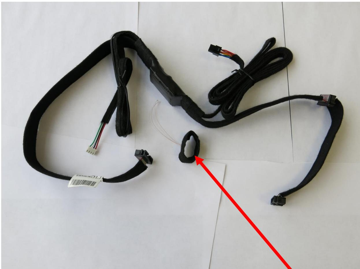
Модуль со штатным шлейфом BMW, антенна на ключ подключается к двум проводам модуля.
