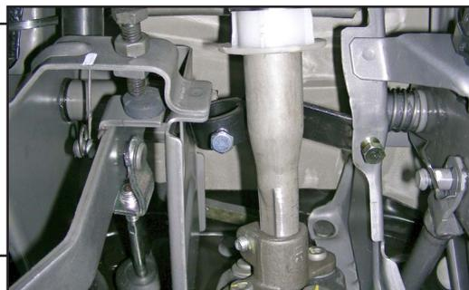
5. Установить на рулевой вал муфту (4) и закрепить болтами (5) в максимально нижнем положении, с усилием 5 н м.
