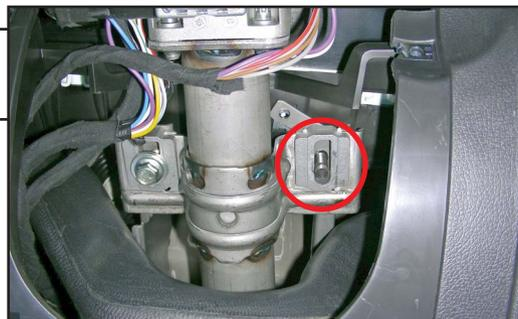
4. Установить кронштейн (3), для этого одной стороной надеть на ось педали сцепления, второй положить на кронштейн педали тормоза. Закрепить кронштейн (3) сначала болтом (6), с усилием 10 н м, затем родной гайкой отвинченной в п.2.
