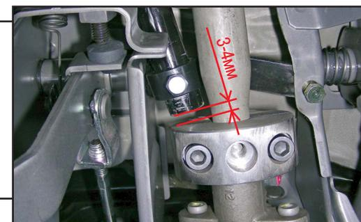
8. Заблокировать рулевой вал штатным замком. Отрегулировать положение муфты так, чтобы блокирующий ригель свободно входил и выходил из паза муфты. Сорвать головки болтов и гаек крепления замка (1).
