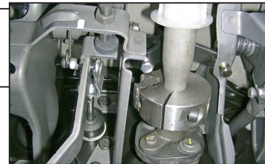
6. Установить замок (1), для этого нужно вставить носик замка (1) в кронштейн (3), после этого закрепить кронштейн личины гайкой (7), крепеж не затягивать.
