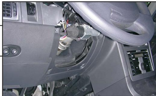
2. Отвинтить гайку крепления педали сцепления. Это удобно делать торцевым ключом на (15) с «трещеткой» вращая за головку болта (ось педали), а гайку держать рожковым ключом.
