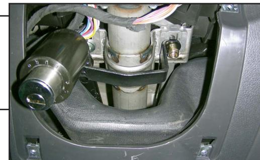
7. Отрегулировать положение замка так, чтобы расстояние от носика замка до муфты было 3-4 мм, при этом личина замка (1) должна быть направлена вниз. Затянуть крепеж замка с предварительным усилием 10 н м.
