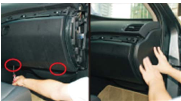
37. Закрутите винты под перчаточным отделением и установите боковую декоративную панель.
