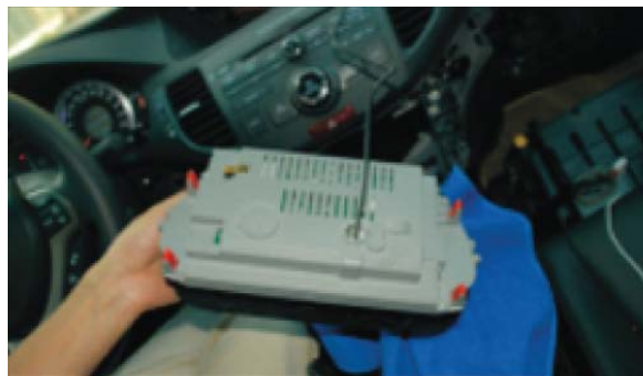
26. Закрепите крепежные элементы на GPS модуле.
