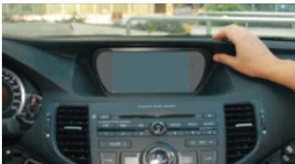
29. Установите GPS экран и подсоедините провода.
