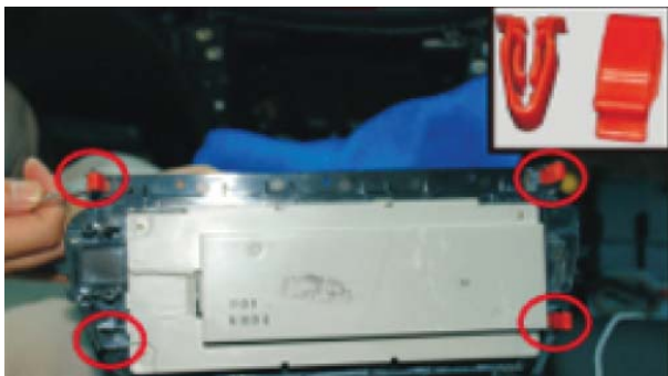
25. Снимите 4 крепежных элемента со штатного экрана.
