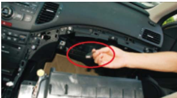
27. Установите USB провод от GPS, как показано на фото.
