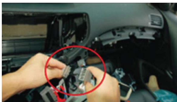
22. Соедините провода микрофона со штатным проводами микрофона.
