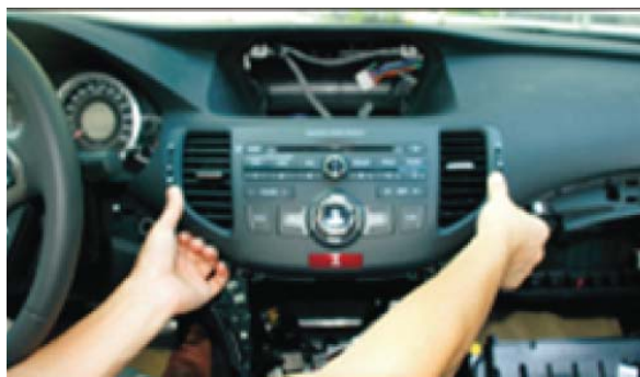
24. Установите головное устройство и закрутите винты.
