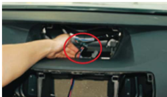
18. Достаньте провода микрофона, как показано на фото.
