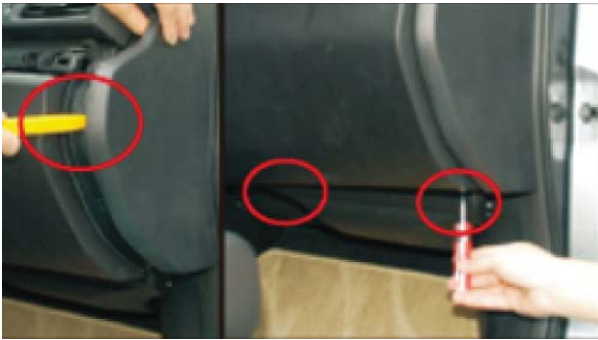
9. С помощью монтажных лопаток демонтируйте боковую декоративную панель, затем открутите винты под перчаточным отделением.
