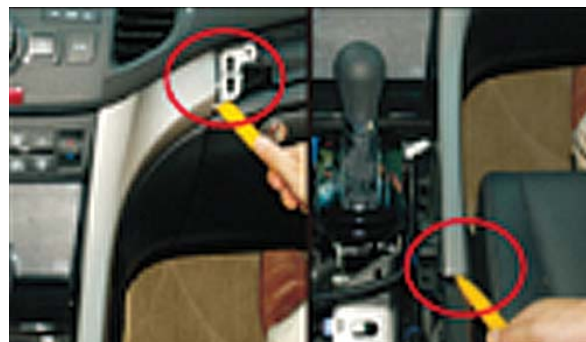
8. С помощью монтажных лопаток демонтируйте декоративную панель.
