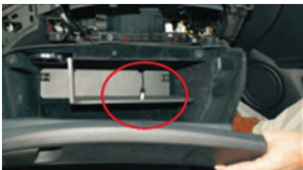
35. Протяните USB разъем в перчаточное отделение.
