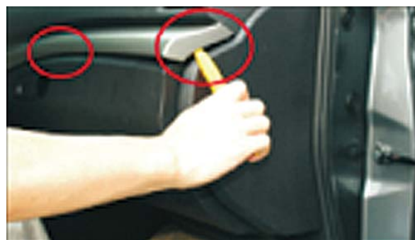
6. С помощью монтажных лопаток демонтируйте декоративную панель.
