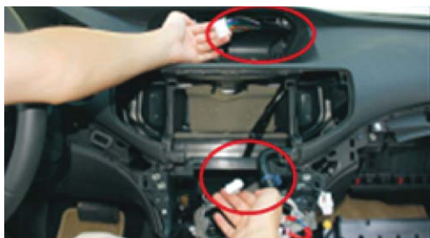
19. Установите проводку DVD, как показано на фото, конец с разъемом протяните сквозь отверстие.
