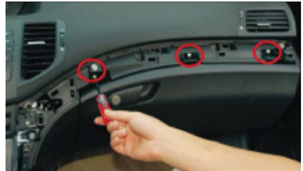
10. Открутите винты над перчаточным отделением и снимите перчаточное отделение.
