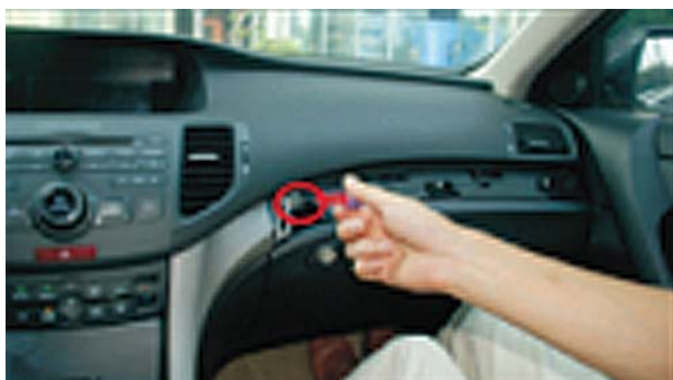
7. Открутите винты фиксирующие декоративную панель.
