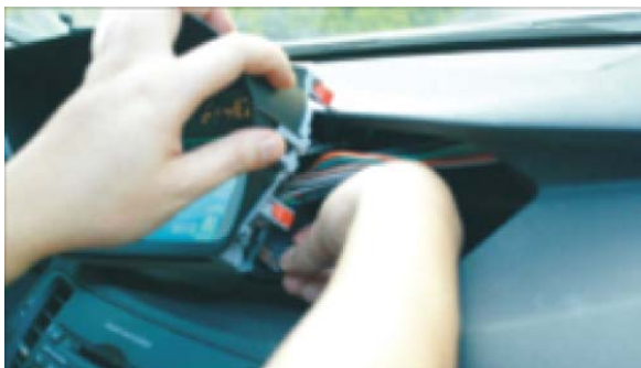
28. Подсоедините проводку GPS модуля.
