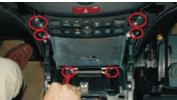
13. Открутите винты крепящие кондиционер и перчаточное отделение.
