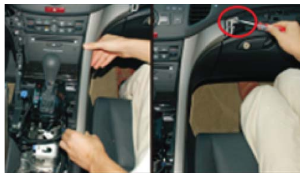
38. Установите и зафиксируйте винтами правую декоративную панель на консоли.
