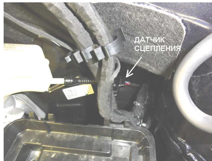
Рис. 4. Место подключения к проводам датчика сцепления а/м Passat B7, Passat CC (за АКБ).
