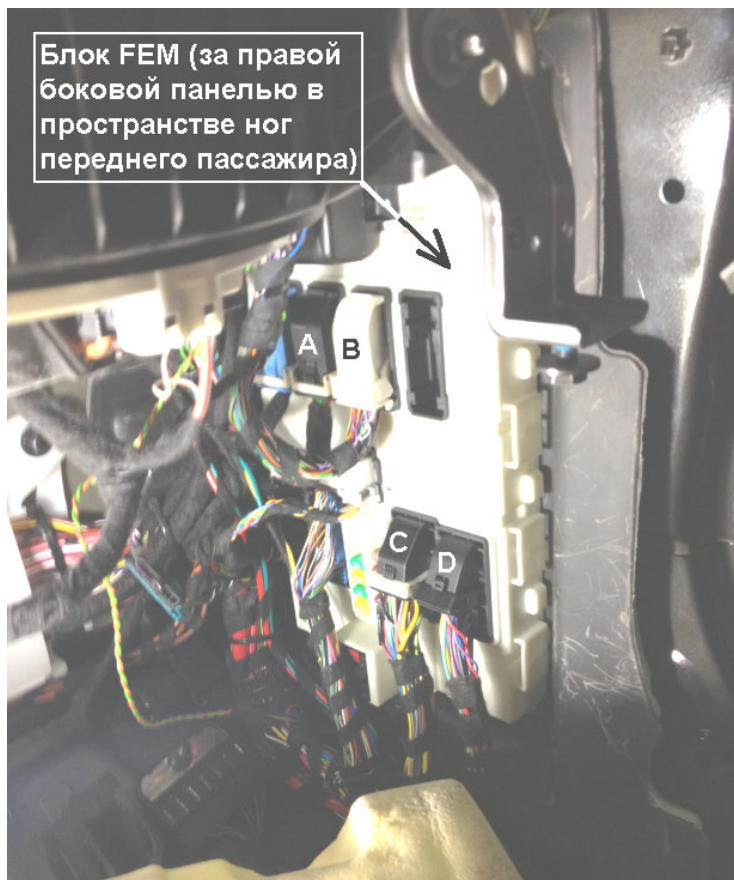
Рис. 5. Расположение и порядок разъемов модуля FEM на а/м BMW 1(F20), 3(F30)
