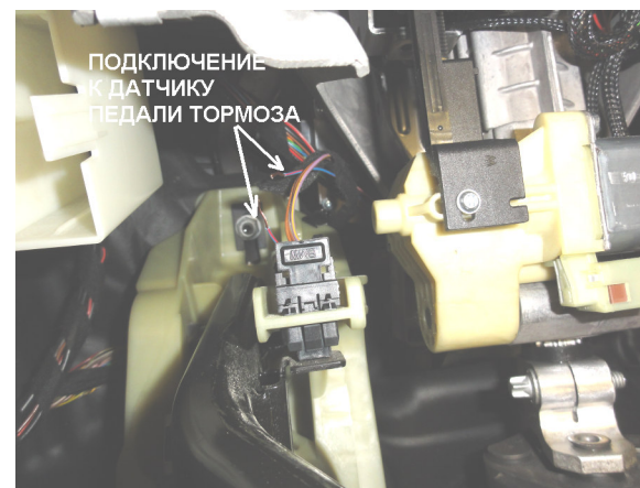
Рис. 3. Место подключения к датчику педали тормоза
