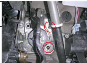
4. Отвинтить нижний правый болт крепления рулевой колонки.
