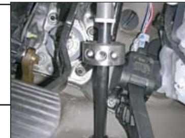
10. Завинтить стопорный болт (4) до срыва головки. **Внимание!** Если стопорный болт попадает в плоскую поверхность рулевого вала, то необходимо сделать углубление в валу  $D=6.5$  мм, глубиной 1 мм, для того, чтобы не произошло нарушение регулировки муфты в момент затяжки болта (4).
