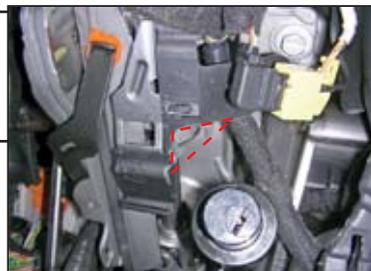
6. Поднять регулирующую рулевую колонку в верхнее положение. Установить замок (1) и закрепить его гайками (7) и болтом (5), крепеж затянуть с предварительным усилием 15 н.м. Опустить регулирующую рулевую колонку в нижнее положение, проверить достаточно ли вырезан пластик кронштейна в п.5. При необходимости удалить упирающуюся в личину замка часть.
