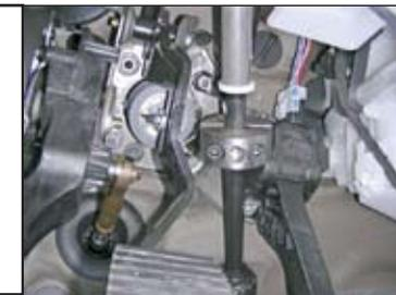
8. Сорвать головки болтов и гаек крепления замка (1).
