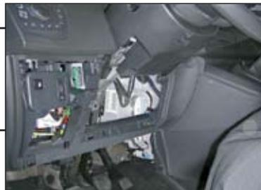
2. Демонтировать нижнюю часть кожуха рулевой колонки.
