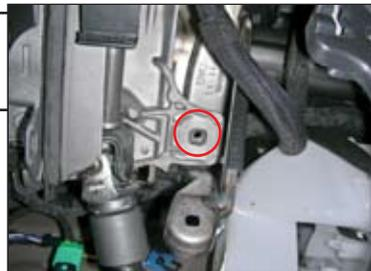
5. Вырезать часть пластикового кронштейна крепления разъема под рулевой колонкой.
