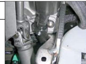
9. Еще раз проверить регулировку муфты. Сорвать головки болтов крепления муфты так, чтобы зазор между половинами был равномерным.
