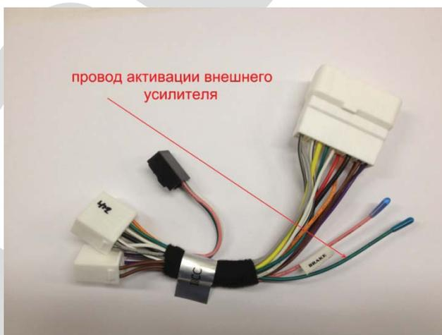
Соедините зелёный провод жгута устройства CHR-3194 с салатовым проводом в жгуте автомобиля и при включении нового головного устройства, будет активироваться оригинальный усилитель автомобиля, в динамиках передних дверей появится звук.
