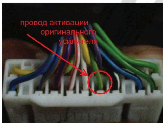
В жгуте проводов устройства CHR-3194 проводом, отвечающим за активацию внешнего усилителя, является выходящий из этого жгута зелёный провод.
