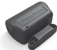
**Датчик двери DMS-100BT** – беспроводное периферийное устройство предназначено для контроля внутреннего или внешнего периметра: контроль любой назначенной охранной зоны – состояние датчика положения (Холла), удара/наклона; контроль температуры. Устройство может быть установлено на створке двери, люка, крышке багажника, крышке прицепа, воротах гаража.
