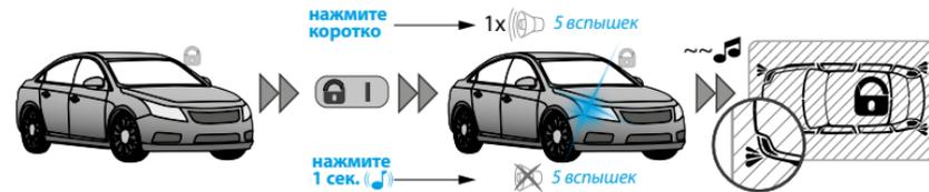
Для того чтобы облегчить поиск своего автомобиля на крупной автостоянке, коротко нажмите на кнопку **G I**, когда автомобиль находится под охраной, система выдаст 5-кратный звуковой сигнал сирены и пять вспышек указателей поворота.
