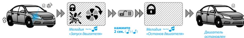
За одну минуту до штатной остановки двигателя на брелок придет оповещение, замигает пиктограмма и каждые 10 сек. будет звучать мелодия «ОСТАНОВ ДВИГАТЕЛЯ ЧЕРЕЗ 1 МИН.»
