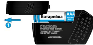
При использовании качественных элементов питания брелок охранно-сервисной системы может функционировать без замены элемента питания до 4 месяцев.
