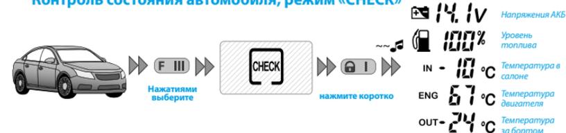
Для получения информации о температуре двигателя и салона, напряжении бортовой сети нажатиями на кнопку **F III** выберите пиктограмму **CHECK** и коротко нажмите кнопку **I**, будет произведен запрос состояния системы.
