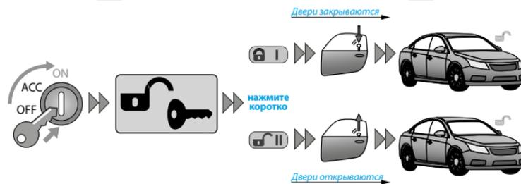
Предусмотрен режим автоматического запирания дверей при начале движения и отпирания дверей при выключении зажигания. Через 5 секунд после включения зажигания двери автоматически запираются, а после выключения зажигания двери отпираются немедленно (программируемая функция). Если после включения зажигания какая-либо дверь открывалась, автоматического запирания не произойдет – это необходимо для предотвращения запирания ключей зажигания внутри автомобиля.
