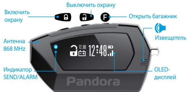
**!** Все команды управления передаются по радиоканалу, при работе с брелоком, для достижения максимальной эффективности и максимальной дальности радиообмена, рекомендуется не закрывать пальцами рук зону встроенной антенны (см. рисунок).
