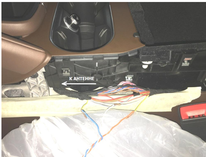
Фото. 1. Подключение к антенне в центральной консоли слева от подстаканников.
