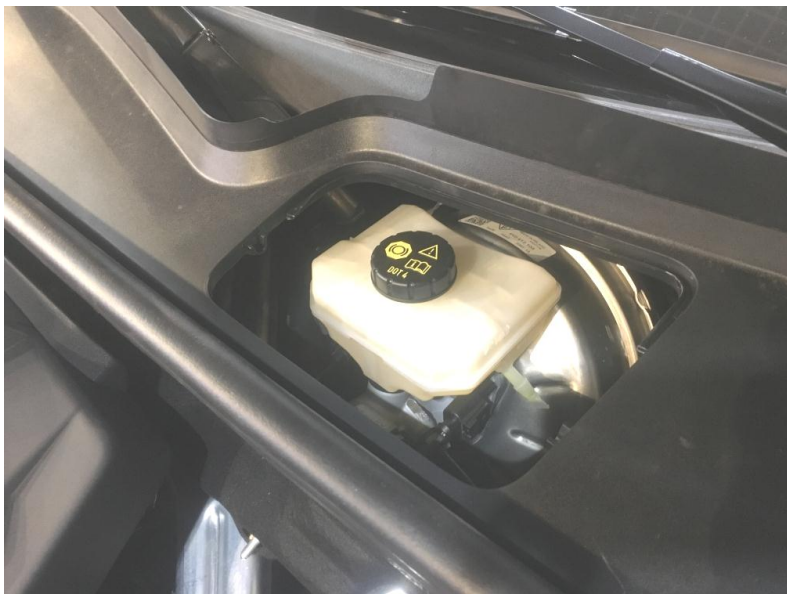
Фото 2. Место лючка для доступа к датчику тормоза.
