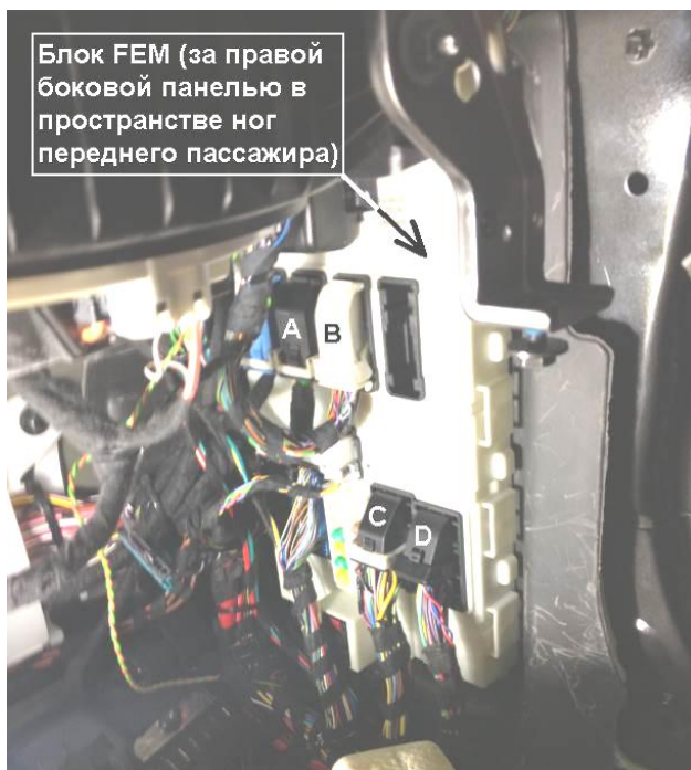
Рис. 4. Расположение и порядок разъемов модуля FEM или BDC
